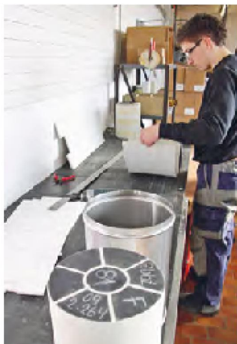
Bei der Tehag Engineering in Diessenhofen werden Russpartikelfiltersysteme für Baumaschinen gebaut.
